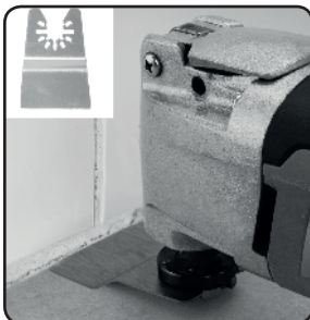
Obr.2, odstraňování zbytků lepidla či tmelů škrabkou
