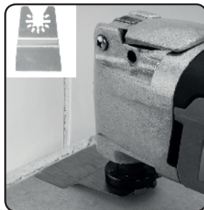
2. ábra. Ragasztó- és tömítőanyag maradványok eltávolítása kaparóval.
