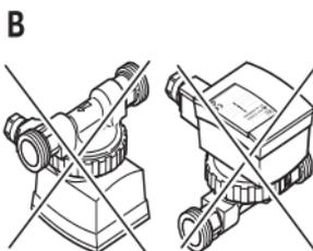
1. Einbauort so vorbereiten, dass die Pumpe frei von mechanischen Spannungen montiert werden kann.
